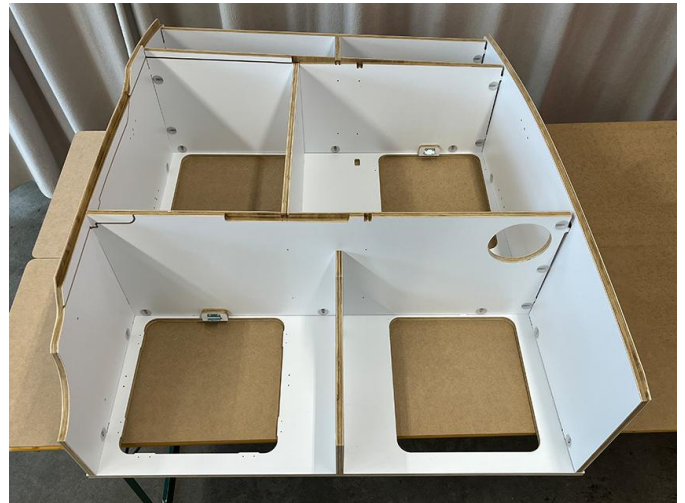
Vordere Seitenwand H10 vorsichtig einsetzen (Zapfen!).
