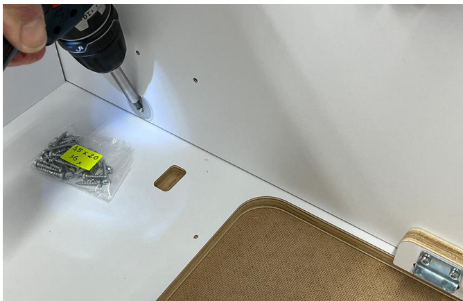
Topverbinder verschrauben: Schrauben 3,5 x 20 mm Anschließend Topverbinder-Kappen montieren.
