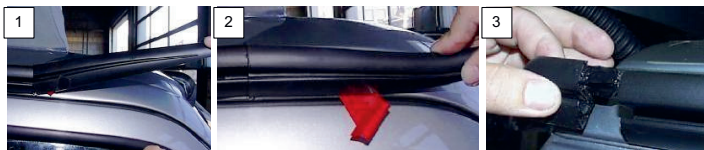
Abb. 5-1: Verklebung der Endstücke / Glueing of the end pieces
