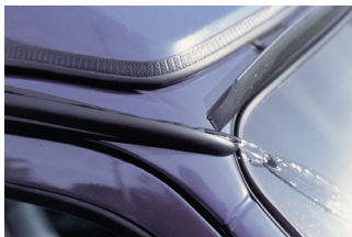
Wasserableitung über Spoilerprofil
